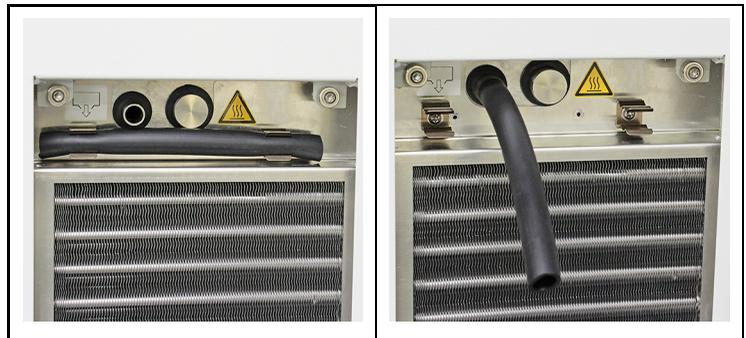
3. 310F und 450F: Entnehmen Sie den Schlauch und stecken Sie ihn auf das Ablassventil [Abbildungen].
